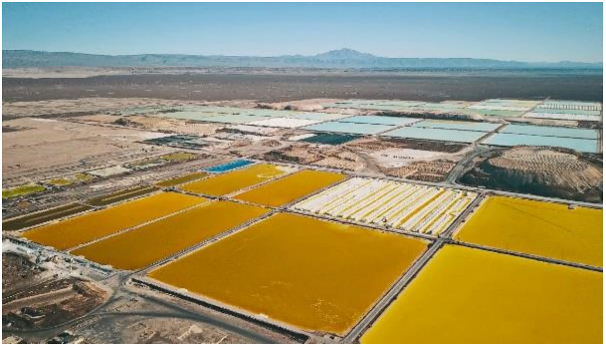
Lithium-Abklingbecken. Atacama; Färbung zeigt Grad der erreichten Wasserverdunstung
